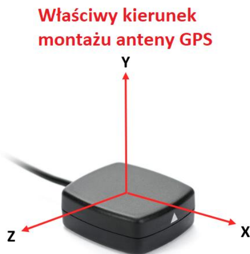
Rysunek 11. Kierunek montażu anteny GPS
